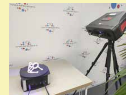
Контроль отклонений геометрии прототипа с помощью 3D сканера
